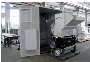
16 Broyeur en cabine acoustique
