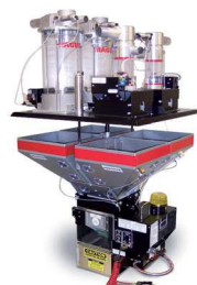
07 WSB - Dosage pondéral de 4 à 12 composants avec capot sur vérins pneumatiques
