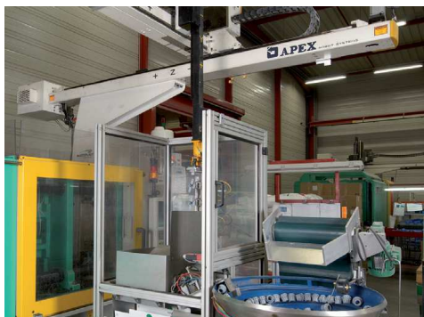
10 Robot pour surmoulage 4 inserts plastiques distribués par bol vibrant et mise en carton des pièces avec comptage
