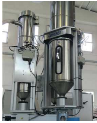
10 DGK - Dosage Grametro Système perte de poids en continu
