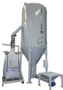
15 Silos mélangeurs à vis verticale Chargement par big bag Déchargement en big bag avec pesage
