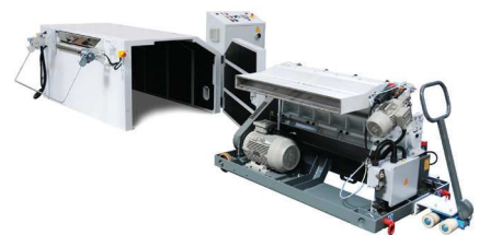
18 Broyeur en ligne pour thermoformage + cabine acoustique
