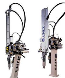
06 Manipulateur pendulaire (pour pièce + carotte) Réf. ST, STV
