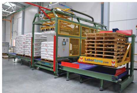
05 LABORSAVE - Dessacheuse 1 300 sacs/h
