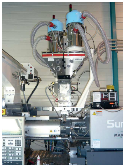
01 INJECTION Doseur pondéral WSB MB sur presse avec support chargeur
