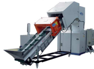
12 Broyeur insonorisé protégé par un tunnel de détection de particules métalliques
