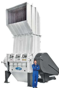
07 Calandrage broyeur grosse capacité jusqu'à 250 kw
