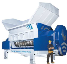
08 Déchiqueteur pour DIB capacité 25 Tonnes/h
