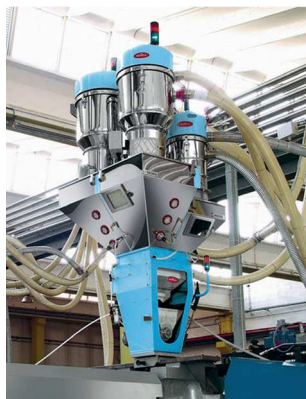
02 INJECTION Doseur pondéral DGM sur presse avec chargeurs
