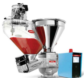
02 DVK - Dosage volumétrique avec trémie Kristal et boîtier avec écran tactile
