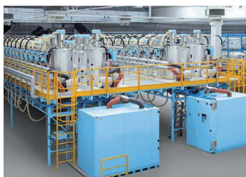
05 Centrale de dessiccation multi trémies multi dessiccateurs
