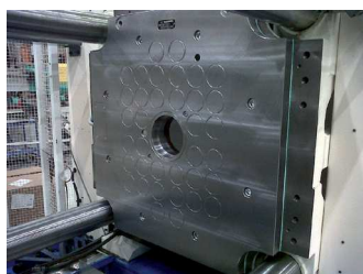
13 Plateaux magnétiques TECNOMAGNETE pour fixation rapide des moules sur presse à injecter de 20 à 10 000 tonnes
