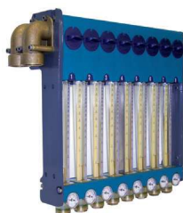
08 Débitmètre multi zones Particularité : 1 seul robinet par zone - Démontage rapide Débit : 10 ou 30 ou 60 L
