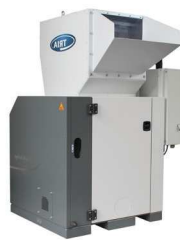
05 Broyeur insonorisé toutes applications de 3 à 75 kw
