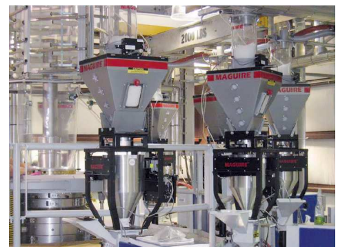
06 FILM Contrôle poids au mètre Réf. LIW
