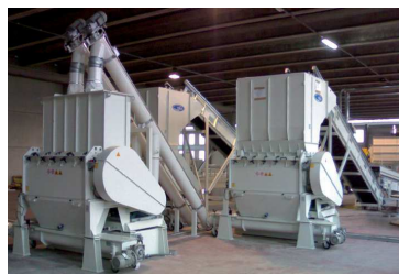
17 Ligne de broyage
