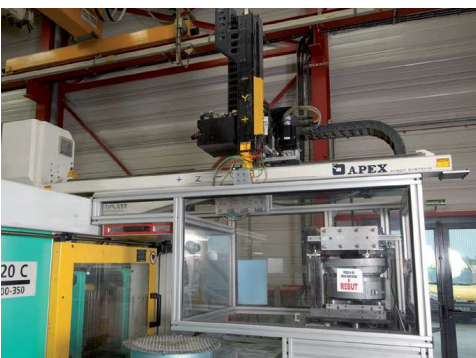
11 Robot pour surmoulage 8 inserts métalliques distribués par bol vibrant et dépose des pièces sur convoyeur ventilé
